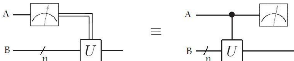
شکل ۲: نمونه‌ای از انتقال اندازه‌گیری به انتهای مدار
